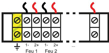
Raccordement par défaut dans le boîtier du bas.
