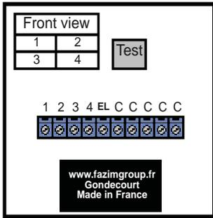
• exemple : 4 fonctions, Bouton + borne essai lampes
